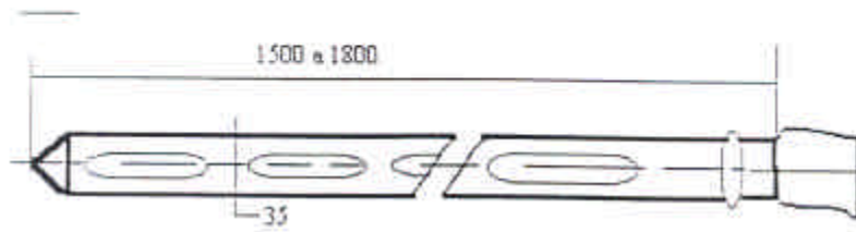
Figura 2 - Tubo amostrador para cimento em sacos
